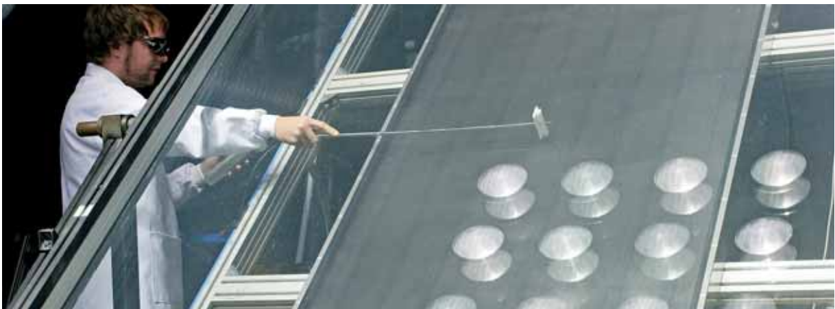
Técnico realizando pruebas a paneles solares térmicos en el Simulador Solar Continuo de CENER
