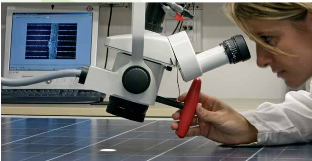
Inspección visual de módulos fotovoltaicos en las instalaciones de CENER
